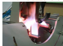
高温高圧試験チャンバーで試作CMC翼の1300℃での健全性実証
