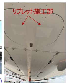
JAL機に施工されたリブレット(オーウエル社)
