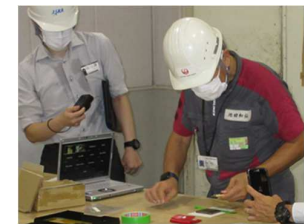
JALによる密着性確認試験 (クロスカット試験の様子)
