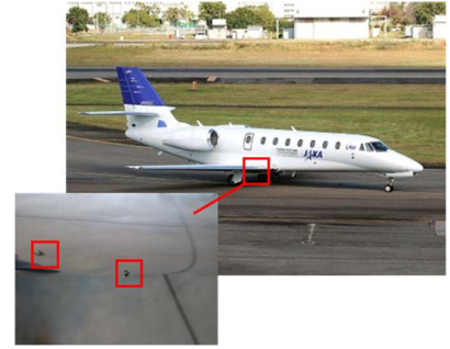
飛行による飛行試験例 虫の付着による汚れによる生成された孤立粗度から遷移誘起
