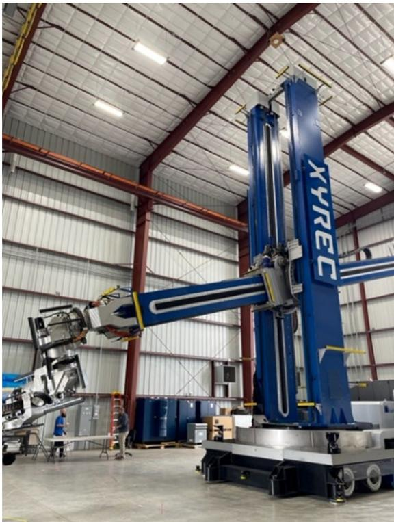
米国の塗装剥離ロボット外観
