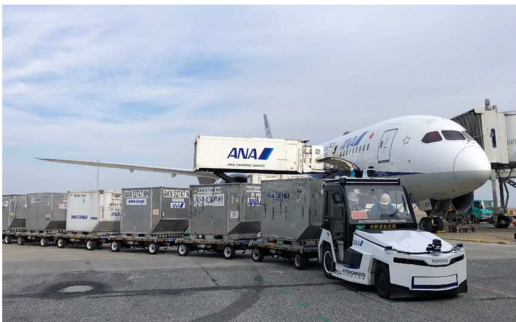
豊田自動織機製3TE25(電動車) をベースに自動運転改造した車両
