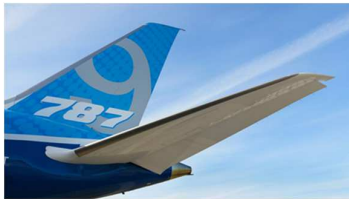
787-9の垂直尾翼 (前縁附近に吸込みを適用したHLFC)
