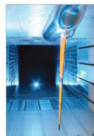
European Transonic Wind-tunnel 設備での風洞試験イメージ(ETW提供) ETW:超低温風洞で実機レイノルズ数を実現
